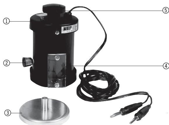
La lámpara de haz único sirve para experimentos de demostración de geometría óptica sobre tableros magnéticos (U14600).
