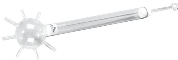
Este equipo sirve para la demostración de la distribución homogénea de la presión en los líquidos en todas las direcciones.
