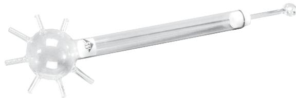
Le dispositif d'expansion de pression permet de démontrer la répartition uniforme dans toutes les directions de la pression dans des liquides.
