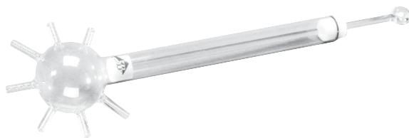
O aparelho distribuidor de pressão serve para demonstrar a distribuição uniforme em todas as direções da pressão em líquidos.
