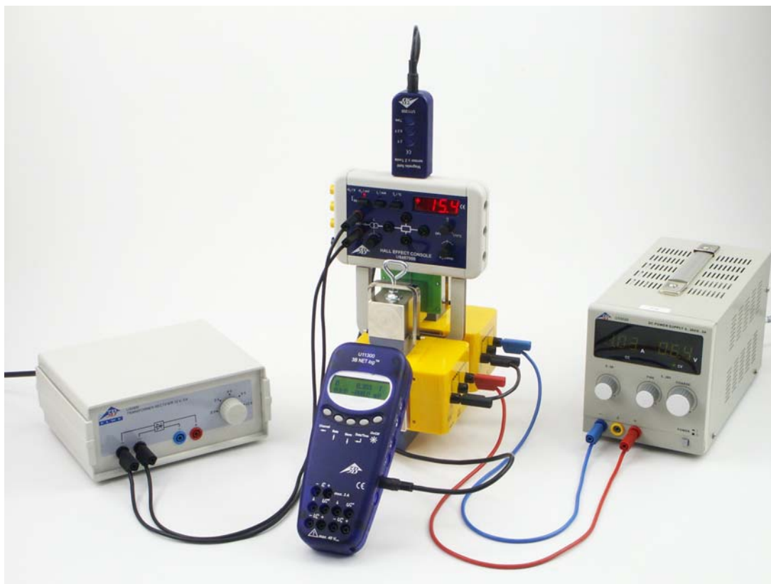
Fig. 1 Messung der Flussdichte im Luftspalt zwischen den Polschuhen eines Elektromagneten im Experimentier­aufbau zum Hall-Effekt-Grundgerät
