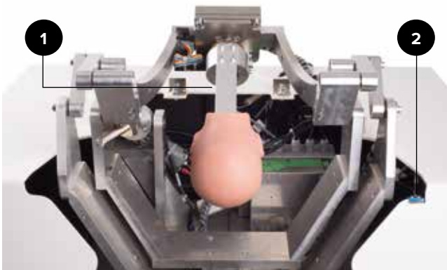
Figura 6: posizione del finecorsa di sicurezza
