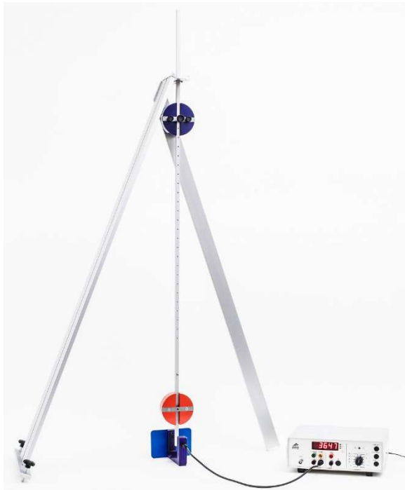
Fig. 5: Experimenteller Aufbau mit Lichtschranke und Digitalzähler
