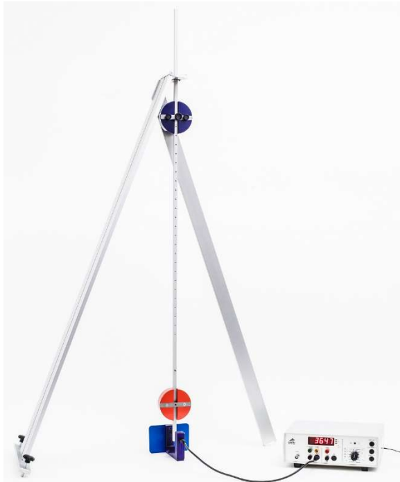
Fig. 5 : Montage expérimental avec barrière lumineuse et compteur numérique
