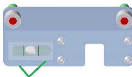
Fig. 3: Ajuste da posição através do nível de bolha de ar
