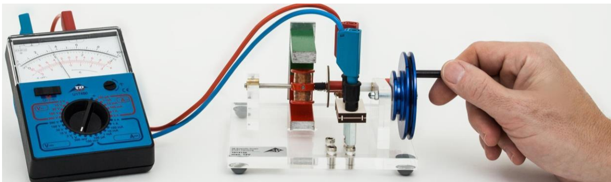
Fig. 3 Betrieb als Gleichstromgenerator mit Vielfach-Messgerät ESCOLA 10
