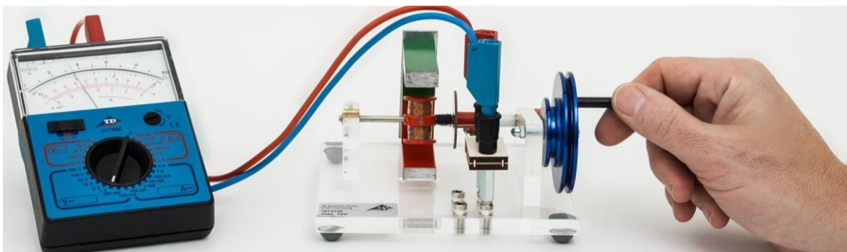
Fig. 3 Fonctionnement comme générateur à courant continu avec le multimètre ESCOLA 70
